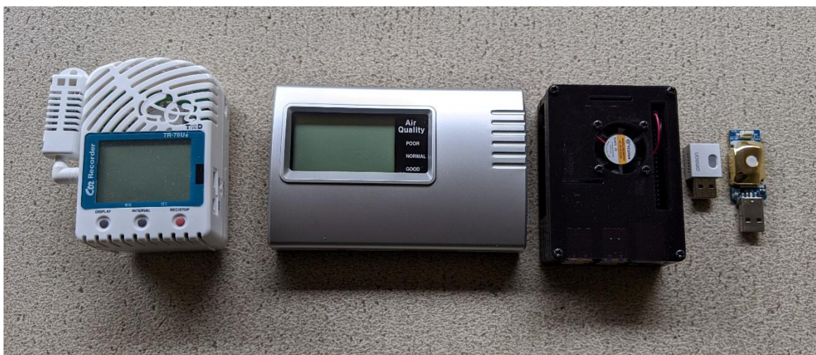
左から、T&D 製 TR-76Ui、ELT SENSOR 製 CO2 モニター-MB350U、ゲートウェイ、オムロン製 環境センサ(USB 型)、ELT SENSOR 製 MT-200
